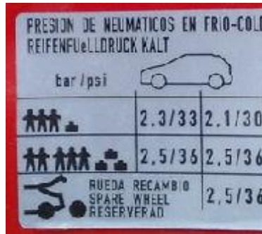
Figura 5: Ejemplo de etiqueta con presiones de inflado de neumáticos
